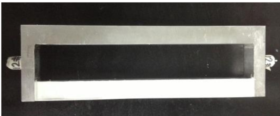
图 1. 防覆冰涂层样件（上面为纯铝，下面为小分子涂层）
